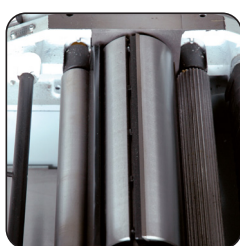
Arbre de dégauchissage de \varnothing 75 mm avec 3 fers 250x30x3
