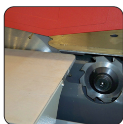
Lame \varnothing 250 mm et inciseur \varnothing 80 mm
