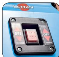
Interruttore ON/OFF con selettore del senso di rotazione
