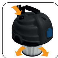
Décolmatage manuel du filtre
