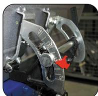
Guida in profilato di alluminio inclinabile a 45°
