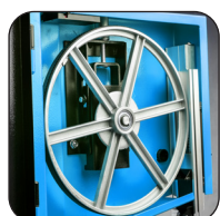
Uitgebalanceerde vliegwielen in gietaluminium en veiligheidscontactsluiters
