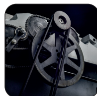
Alimentazione rulli a catena, trasmissione motore a doppia cinghia
