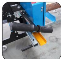
Poignée réglage pour la tension de la lame
