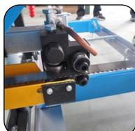
Guida e protezione della lama regolabili
