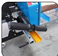
Maniglia di regolazione della tensione della lama
