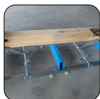
Sistema de retención de troncos
