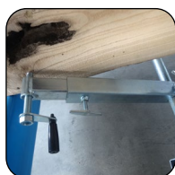
Sistema de retención de troncos
