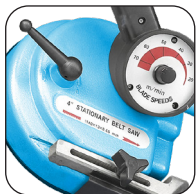
Toerenregelaar de snelheid, snelle ontgrendeling van het blad
