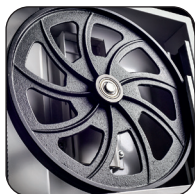
Uitgebalanceerde vliegwheels in gietstaal
