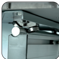
Slede voor plugboren met glijdsysteem op kogellagers
